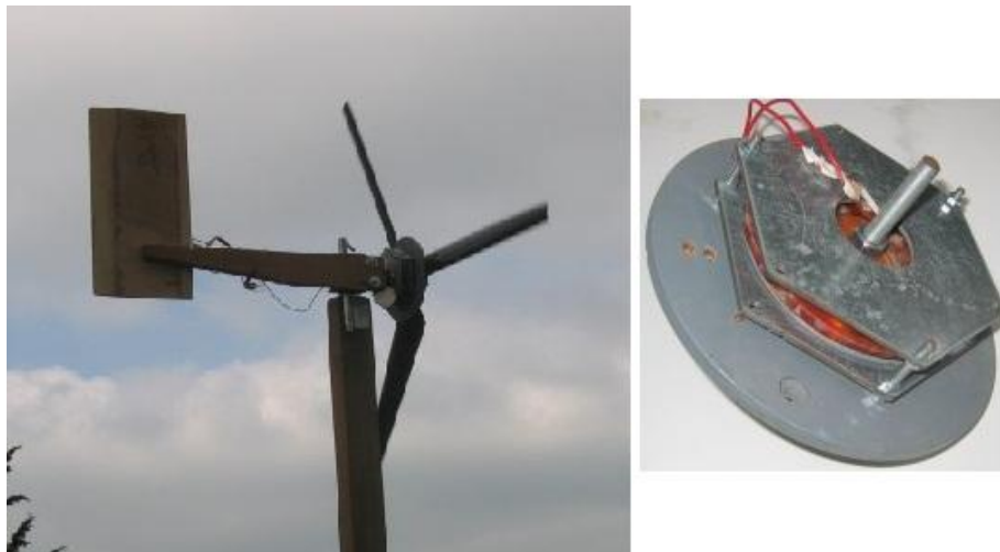
Figuur 5: DIY windturbine met bijhorende axiale flux generator
