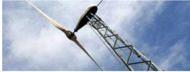
Figuur 6: De Gaia Wind turbine met asynchrone generator
