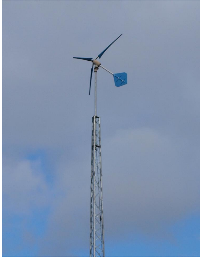
Figuur 16: 'Furlende' windturbine (bemerkt 45° horizontale hoek)
