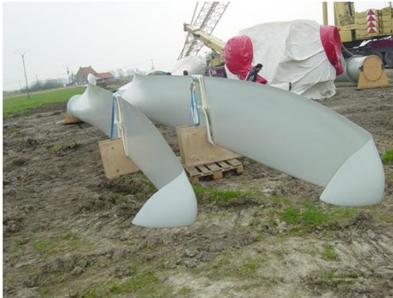
Figuur 10: Wieken grote windturbine met torsie
